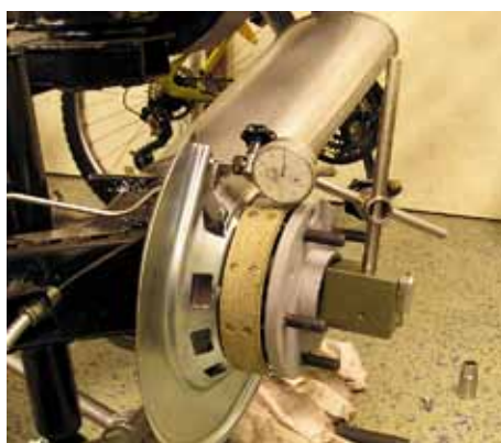
Mäta hjullagerspel innan ihopmontering är viktigt. Men snälla, du tänker väl inte använda handbromsen när bilen är ihopsatt. Nedan åter en detaljbild, som visar att Svempa lämnar inget åt slumpen.
